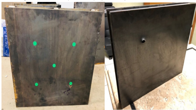
Figura 6 – Aço grau LNE 900 (3,00mm) após disparos, fotos dianteira e traseira.
