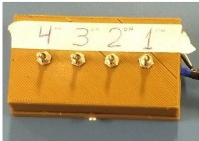
FIGURA 12: Chaves em paralelo acopladas em paralelo na caixa do Labirinto Musical
