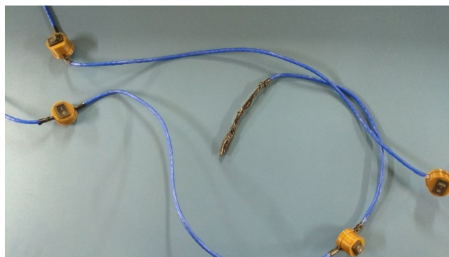
FIGURA 13: Botões nas proteções ligados em serie do Labirinto Musical
