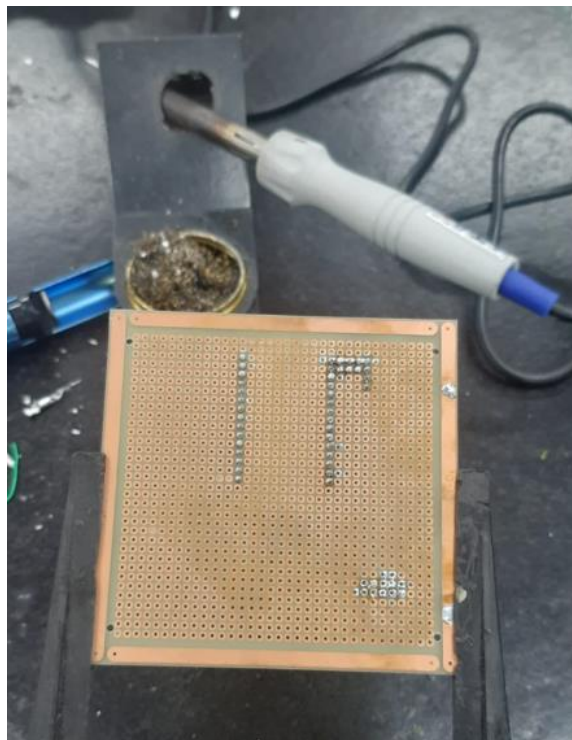
Figura 8 – Trilhas de solda sendo colocadas sobre a placa ilhada através de cordões de solda de estanho
