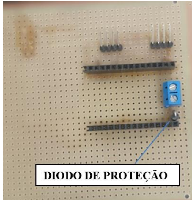
Figura 9 – Soldagem dos terminais e borne na placa ilhada, observa-se o diodo de proteção de sobre tensão.
