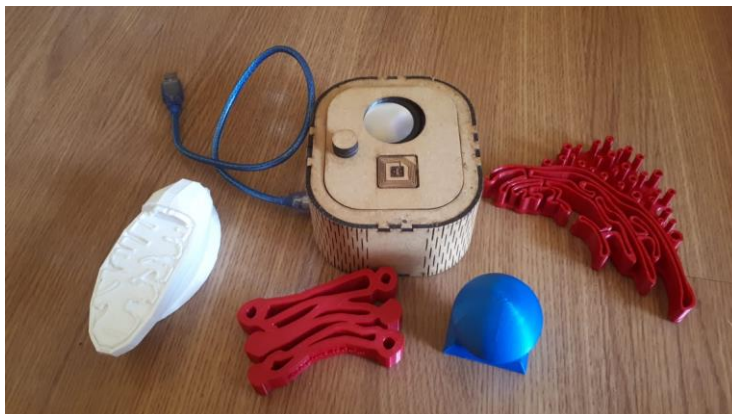
Figura 60- Kit com circuito encapsulado e quatro organelas impressas
