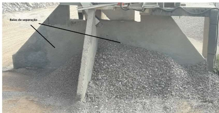
Figura 2 – Separação do material pela Recicladora.
