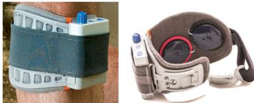
Figura 25: Aparelho para FES, Modelo Walkaide
