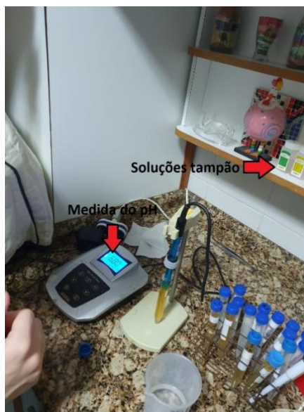
FIGURA 9 – Medição do pH depois de calibração com soluções tampão.
