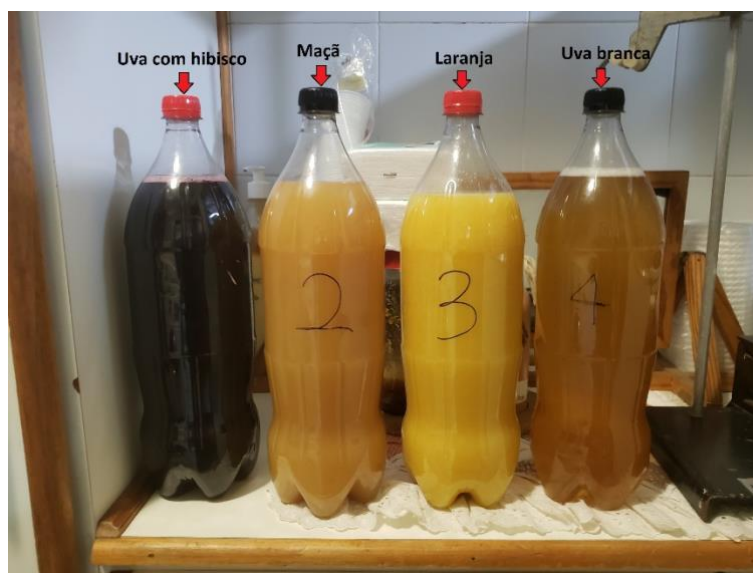
FIGURA 5 – Fermentação dois para degustação utilizando inóculo da primeira fermentação e sucos de fruta industrializados em garrafas PET.
