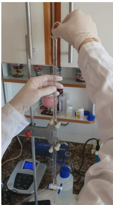
FIGURA 14 – Preenchimento da bureta com NaOH para titulação das amostras de Kombuchá.
