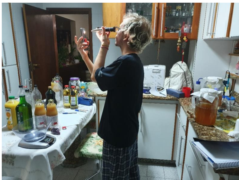
FIGURA 13 – Medida dos Graus Brix das amostras com um refratômetro.
