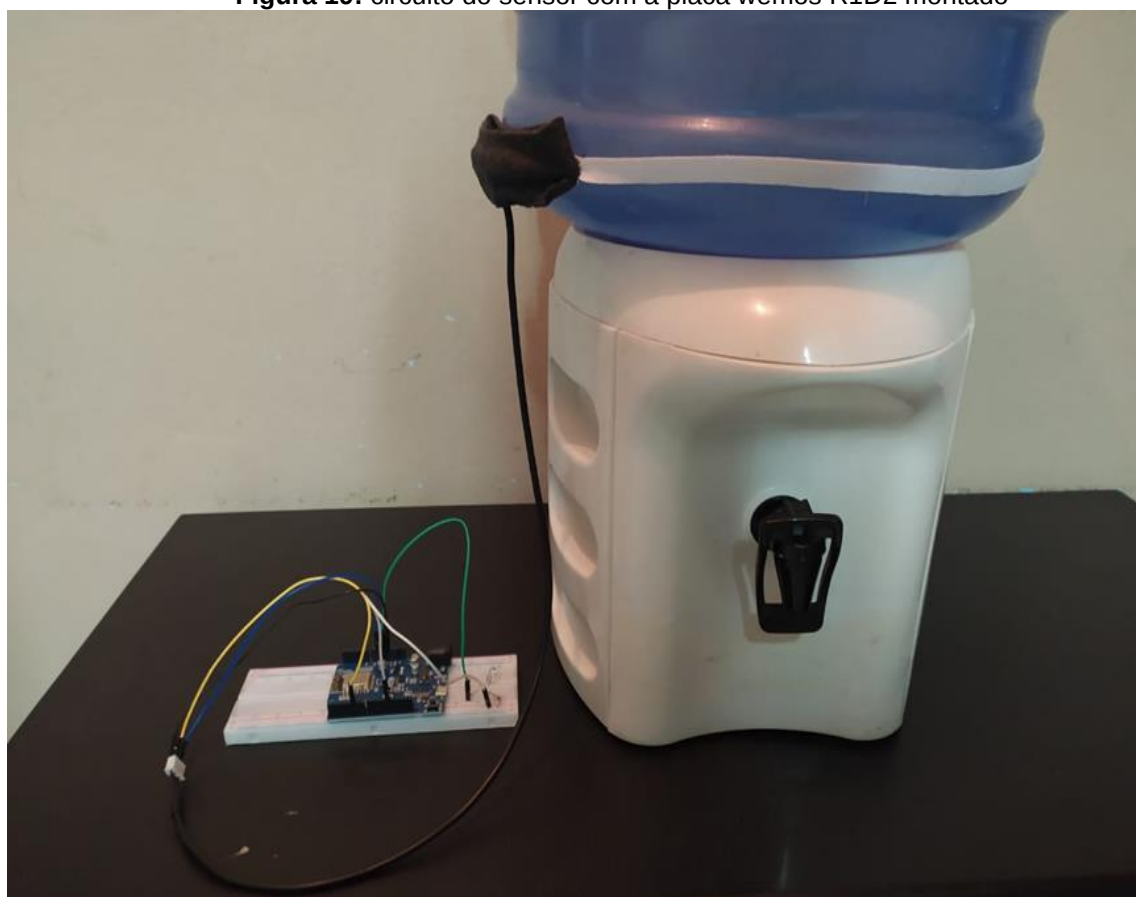
Figura 19: circuito do sensor com a placa wemos R1D2 montado
